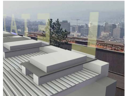
digitales 3d Modell, Montageprinzip: Glasbuchstaben in Metall-U-Profilen geklebt, verschraubt. U-Profile an Konsolen-Bodenplatte angeschraubt. Konsole frei auf zwei Betonbalken gelegt. Diese frei auf Dachtrapezblech aufgelegt (evt. auf Auflageplatte, Faserzement). Verkabelt.
